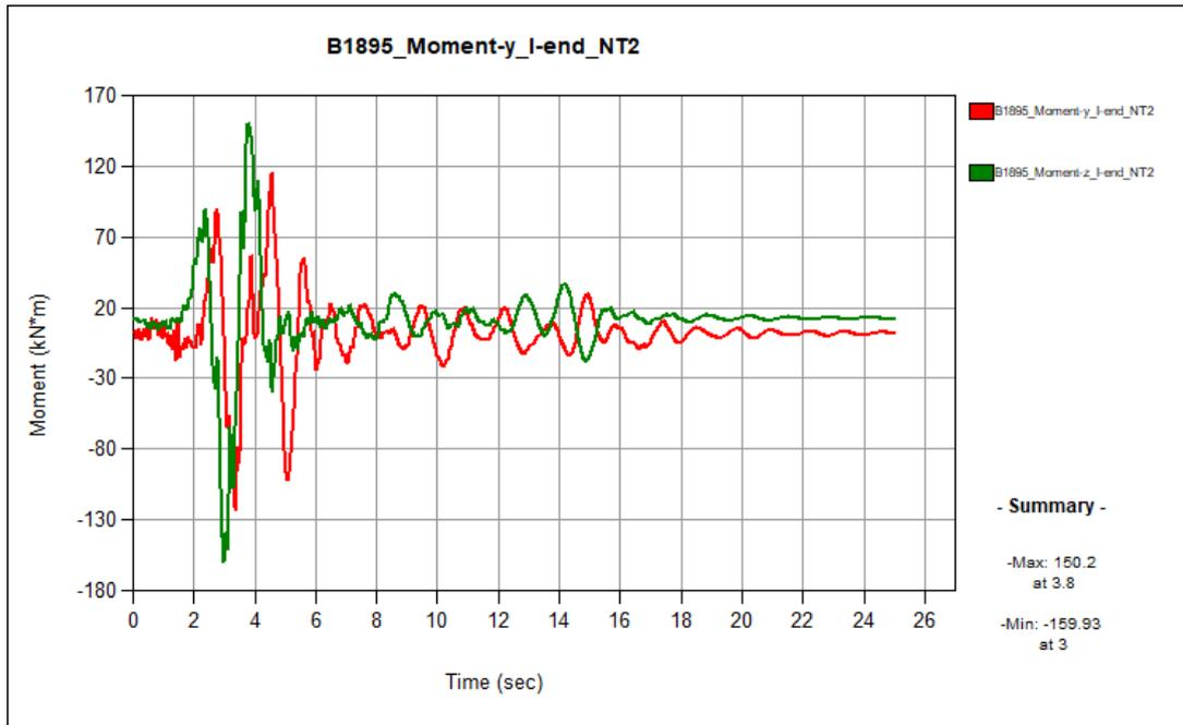
Figura 34 – Momento in direzione y e z pilastro n. 1895
